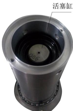
f. 关掉卸压阀用预压泵轻轻地加压，直到活塞缸的缸孔有油溢出即可再将活塞杆垂直插入活塞缸中（如下图）。
